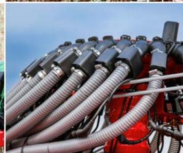
Robuste Überwachungssensoren für Saatgut und Dünger
