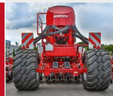
Optional: Bereifung 710/50–26.5 für maximale Aufstandsfläche
