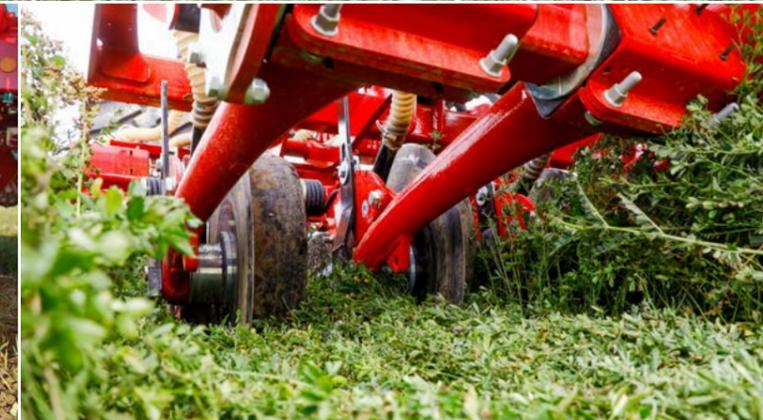
**1** Schließrolle aus Stahl – Wahlweise Stahl- oder Gummischließrollen
