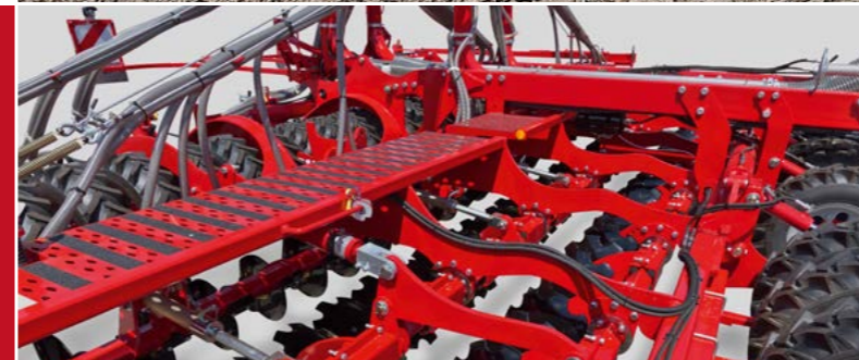
Trittbretter über dem DiscSystem um sicher an jeden Punkt an der Maschine zu gelangen
