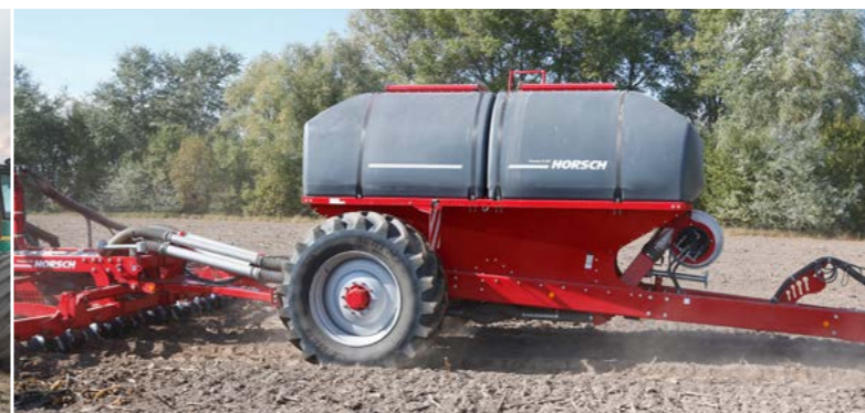
HORSCH Säwagen mit 12 000 Litern Inhalt für Saatgut und Dünger (Teilung 50:50)
