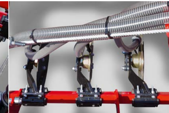
Variable Tiefeneinstellung Düngerablage zwischen zwei Saattrihen mittig zum Packerreifen
