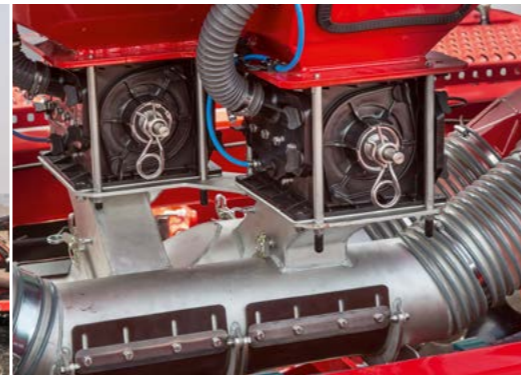
Doppelfallschleuse für gleichzeitiges Ausbringen von Dünger in einem Strom
