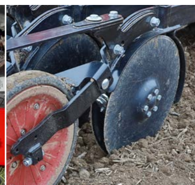
Doppelscheiben-Säschar Gerade Scheibe mit innenliegendem, wartungsfreiem Lager
