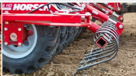
Hydraulisch verstellbare Crossbar für zusätzliche Einebnung
