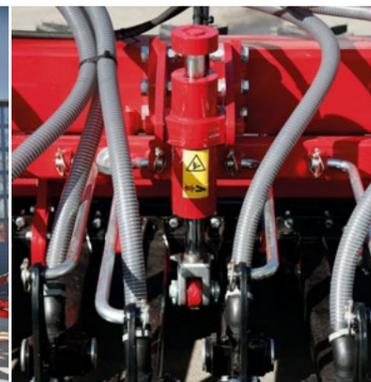
Schardruckeinstellung stufenlos hydraulisch verstellbar
