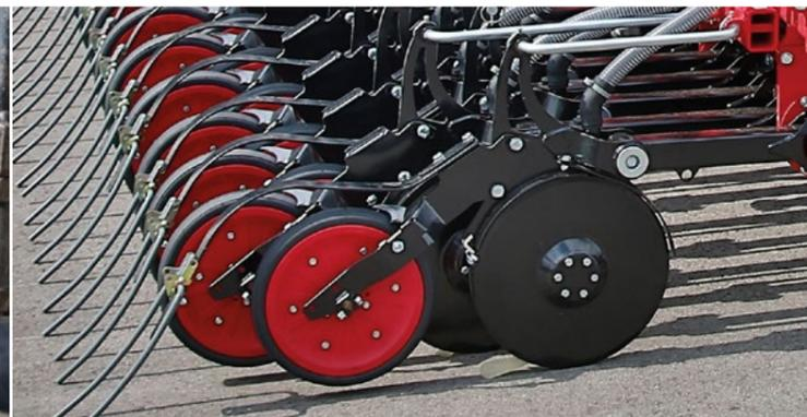
PowerDisc mit Parallelogrammaufhängung
