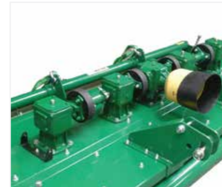
Aandrijving d.m.v. tandwielkasten
