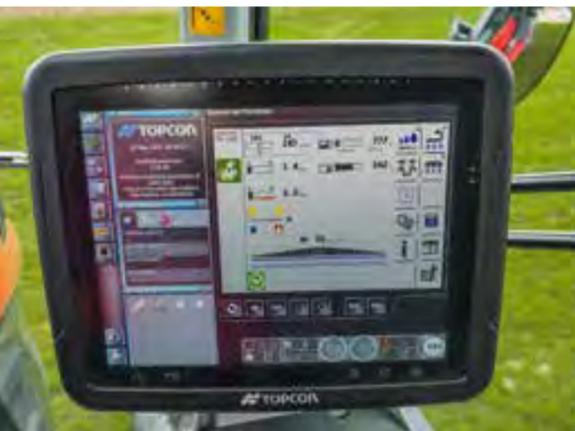
Die Bedienung der Gestängesteuerung erfolgt über das Terminal.
