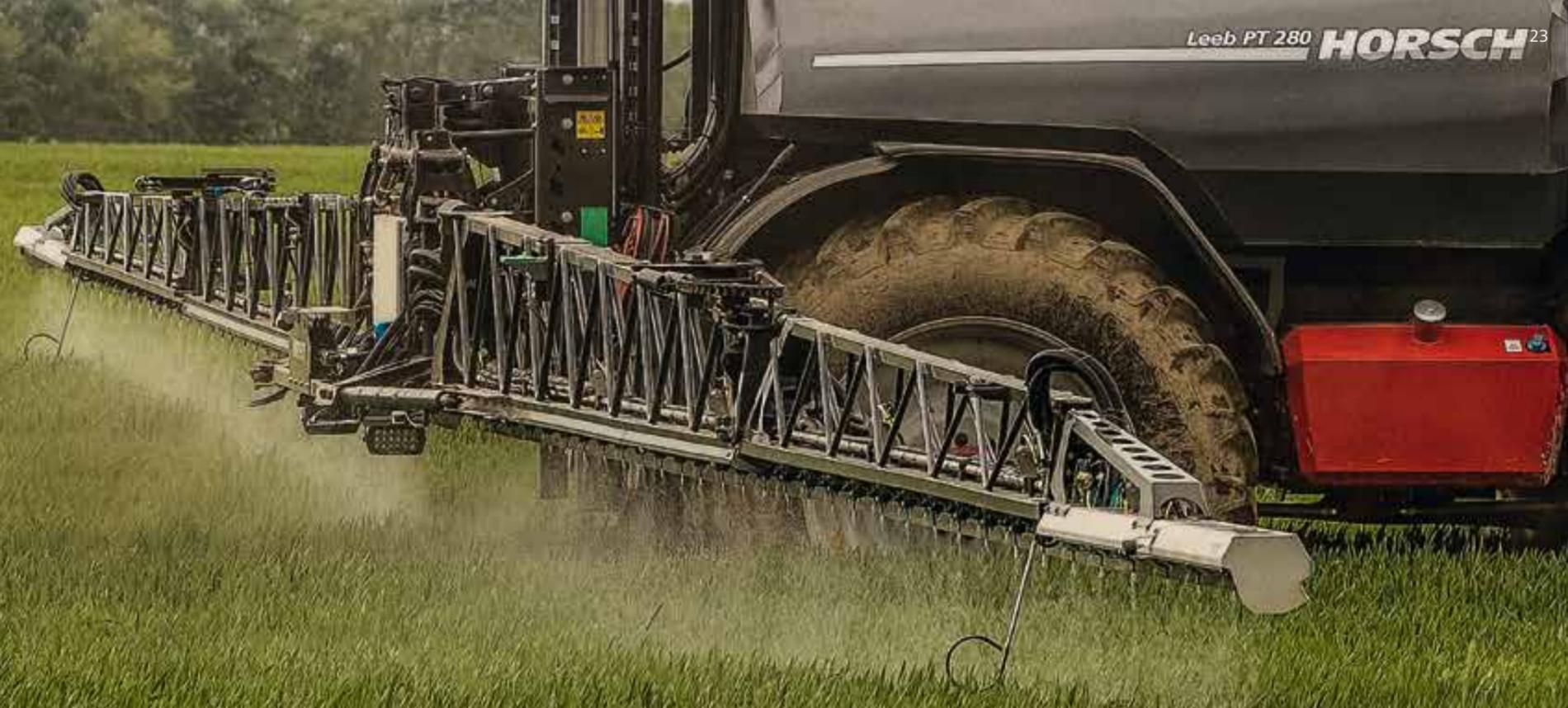
**Mit 25 cm Abstand zwischen den Düsen und HORSCH BoomControl kann der Zielflächenabstand auf deutlich unter 50 cm reduziert werden. Weniger Abdrift und hervorragende Benetzung!**
