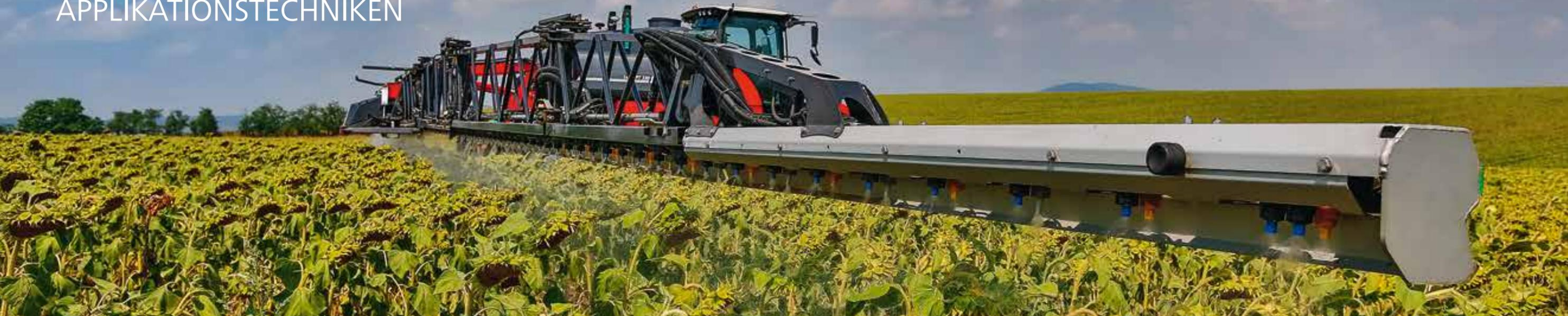
**Mit 25 cm Abstand zwischen den Düsen und HORSCH BoomControl kann der Zielflächenabstand auf deutlich unter 50 cm reduziert werden. Weniger Abdrift und hervorragende Benetzung!**
