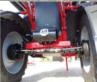
Drei Federungsvarianten zur Auswahl: ungefedert, Elastomer-Puffer und pneumatische Federung
