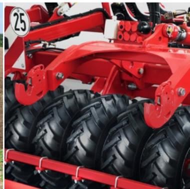
Unterlenker Anbaurahmen mit hydraulischen und elektrischen Anschlüssen
