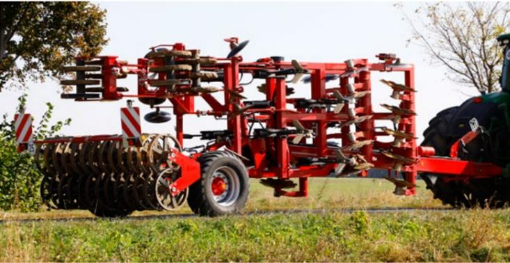
Schwenkfahrwerk in Transportstellung
