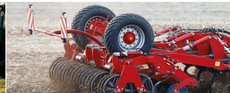
**Schwenkfahrwerk in Arbeitsstellung**
