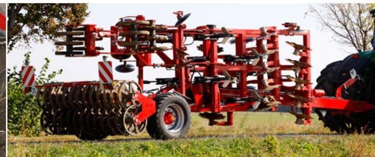
**Schwenkfahrwerk in Transportstellung**
