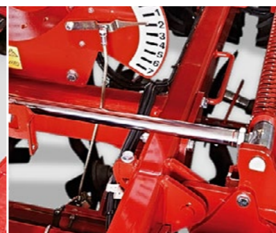
Übersichtliche Tiefenverstellung Während der Fahrt hydraulisch verstellbar
