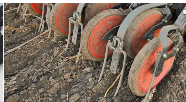
Doppelscheiben-Säschar Gerade Scheibe mit innenliegendem, wartungsfreiem Lager
