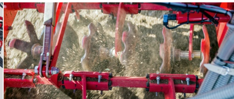
2-reihiges DiscSystem – deutlich geringerer Kraftbedarf im Vergleich zu aktiven Vorwerkzeugen (z. B. Kreiselegge). Gute Saatbettvorbereitung bei hohen Arbeitsgeschwindigkeiten.
