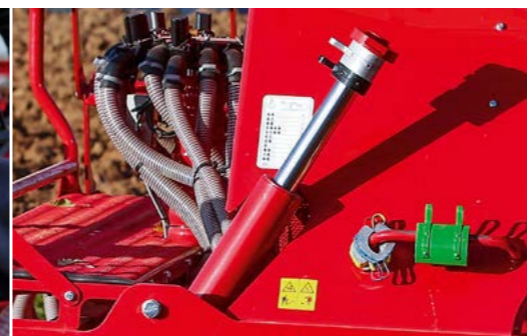
Hydraulische Sätiefenverstellung mit Clips
