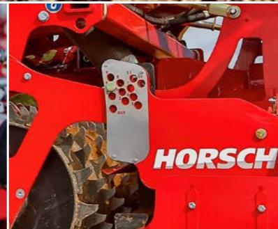
Einfache und leicht verständliche Einstellung der Kreiseleggen Arbeitstiefe.
