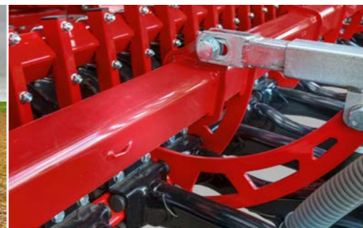
Stufenlose Schar- und Sätiefenverstellung Manuelle Einstellung erhöht die Vorspannung der Gummielemente
