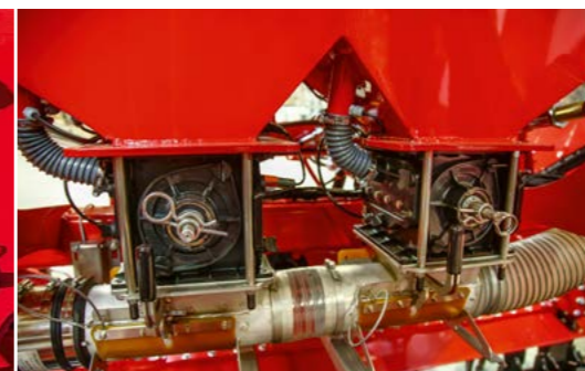
Doppeltank-Version mit dem Grain & Fertiliser System (45 : 55)
