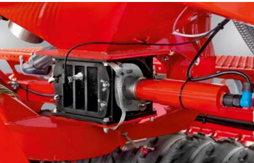
Dosiergerät – elektrischer Antrieb zur Dosierung des Saatgutes. Ermöglicht schnelles, einfaches und genaues Abdrehen.
