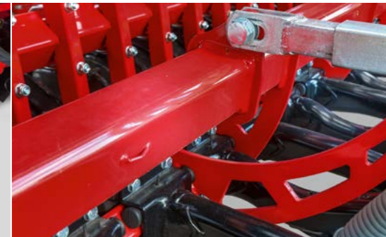
Stufenlose Scharldruckverstellung Manuelle Einstellung erhöht die Vorspannung der Gummielemente
