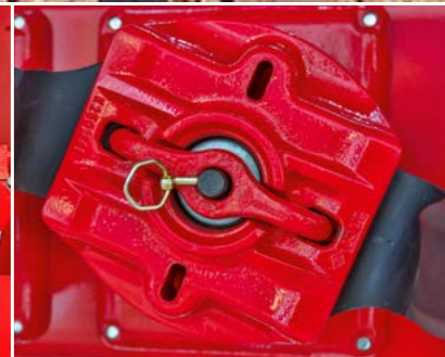
Zinken mit Schnellwechselsystem
