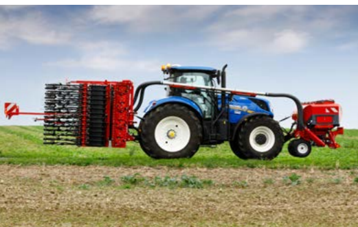
Transportstellung Hydraulische Klappung mit einer Transportbreite von unter 3 Meter
