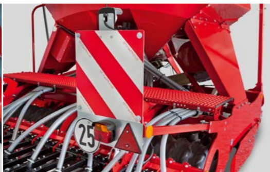
Straßenbeleuchtung für einen sicheren Transport
