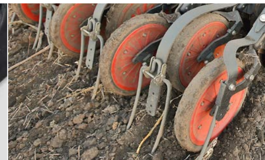
Doppelscheiben-Säschar Gerade Scheibe mit innenliegendem, wartungsfreiem Lager
