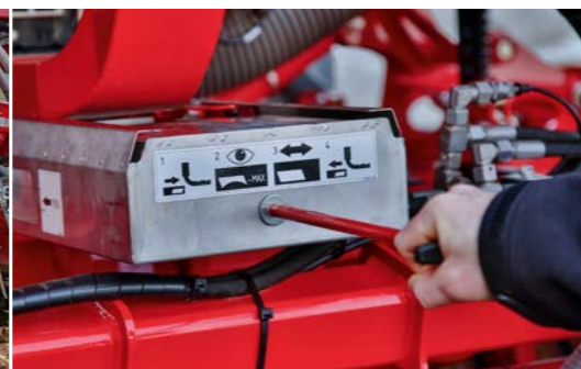
Einfache und sichere Abdrehprobe mit einem Schieber (öffnet und schließt automatisch), ohne tief in die Maschine greifen oder steigen zu müssen
