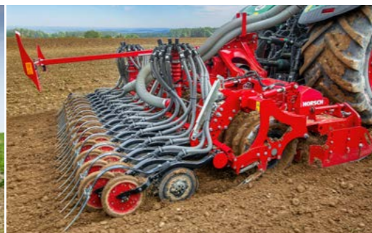
Kompakte Einheit aus Kreiselegge, Packer und Säscharen für günstige Gewichtsverteilung
