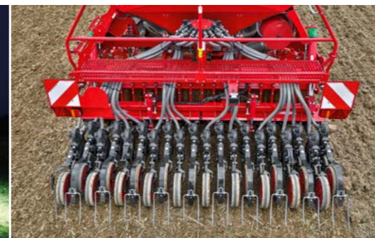
Die optimale Anordnung der Säschare hinter dem Streifenpacker. Ein Sächar läuft immer exakt dort, wo rückverfestigt wurde.
