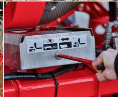
Sichere und einfache Abdrehrprobe. Von Maschinenrückseite aus bedienbar, Abdrehrklappe öffnet und schließt selbständig.
