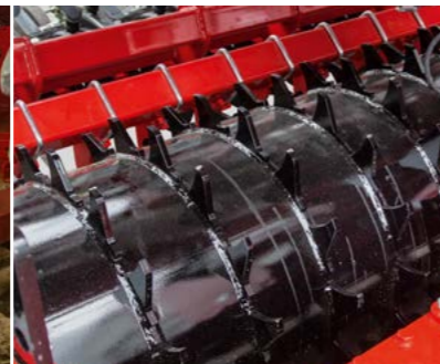
Universelle Zahnpackerwalze mit großem Durchmesser
