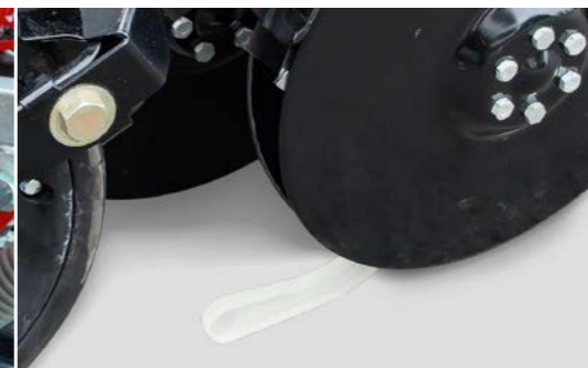
Uniformer und Abstreifer Sichere Saatgutablage in feuchten Bedingungen
