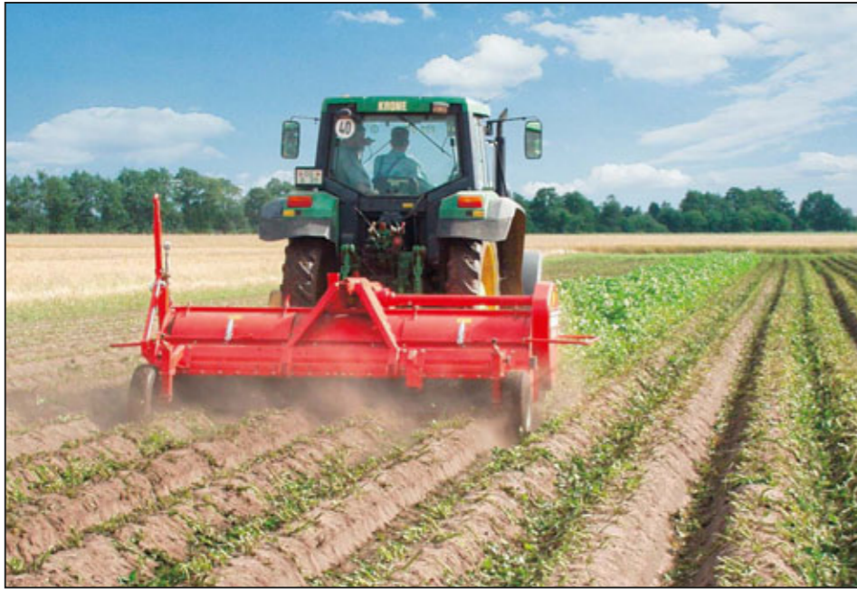
Slagvaardig: de vier-rijige loofklapper van Grimme
