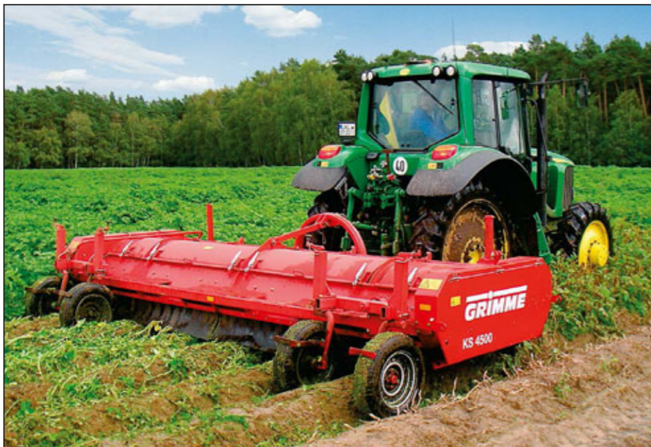
Voordeel in rijen: de zes-rijige loofklapper van Grimme
