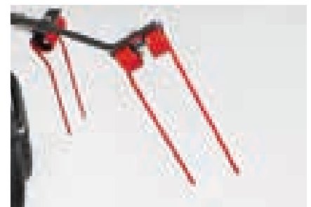
Zinkenhalter mit Zinkenverlustsicherung
