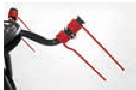
Zinkenverlustsicherung aus Kunststoff
