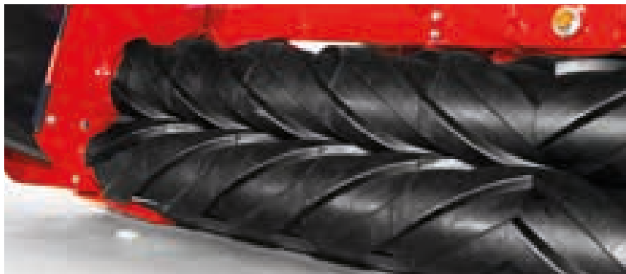
Gummiwalzenaufbereiter (RC) ermöglicht ein gleichmäßiges Aufbereiten des Futterklee. Die Intensität des Aufbereitens kann stufenlos eingestellt werden.
