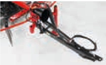
Kleiner Wenderadius durch Anhängung an die Ackerschiene des Zugfahrzeuges
