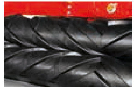
Gummiwalzenaufbereiter (RC) ermöglicht ein gleichmäßiges Aufbereiten des Futterklee. Die Intensität des Aufbereitens kann stufenlos eingestellt werden.
