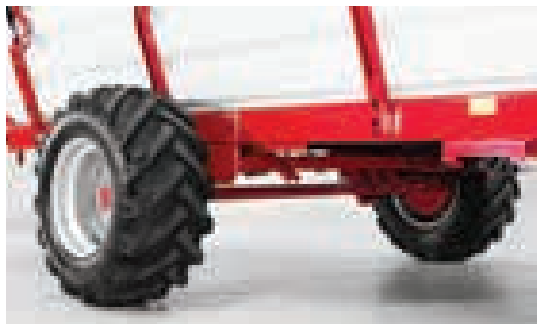
Option mit den Tieflader Fahrwerk und die Traktor-Profil Reifen
