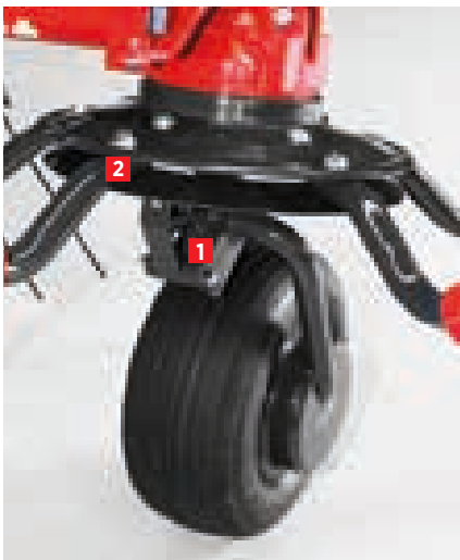
Streuwinkelverstellung (1) und Grenzstreueinrichtung (2)
