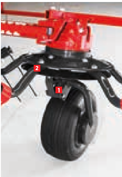
Streuwinkelverstellung (1) und mechanische Grenzstreueinrichtung (2)
