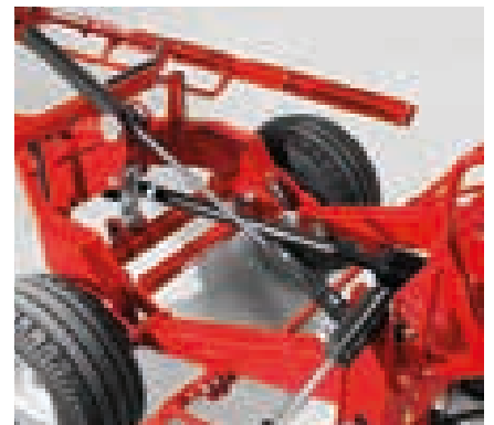
Einstellung der Neigung des Rotors von 10 ° bis 19 °
