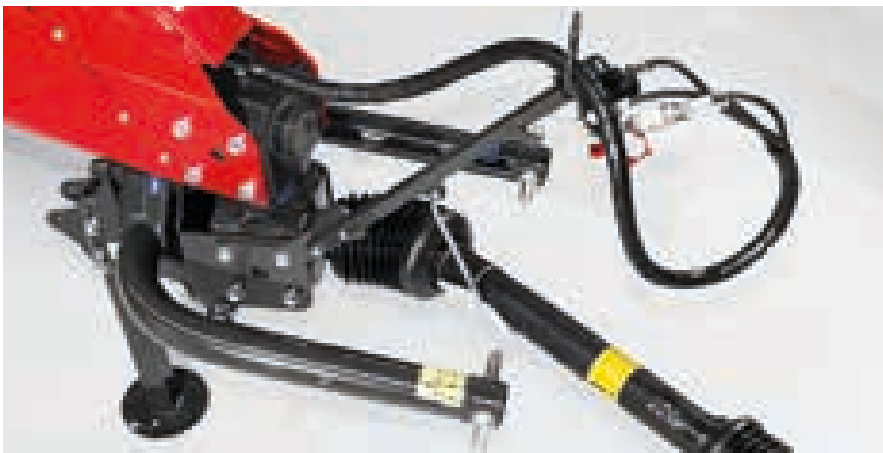
Winkelgetriebe 90° horizontal derbar
