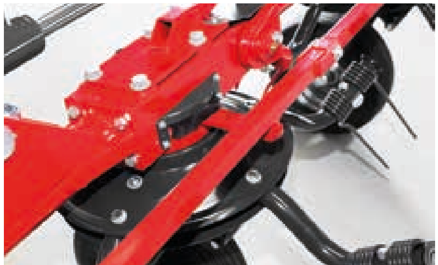
Hydraulische Grenzstreueinrichtung bei HS-Modellen
