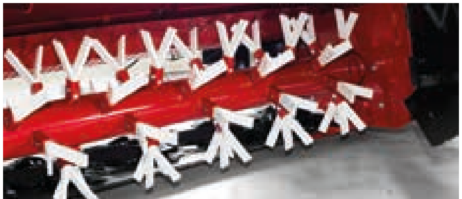
Zinkenaufbereiter (FC) mit Einstellbarer Aufbereitungsintensität und Kunststoffzinken für optimale Aufbereitung.
