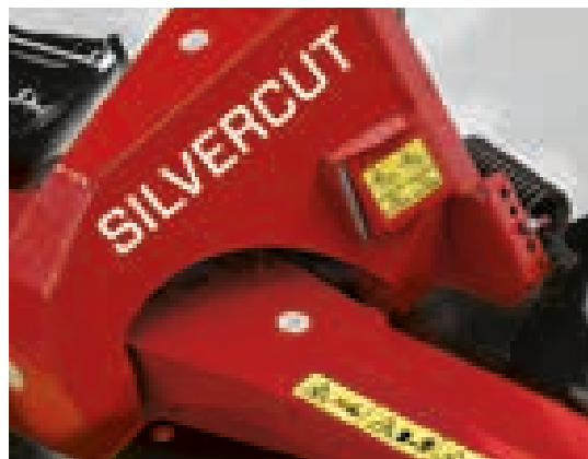
Ansatzstück für Schnellkuppeldreieck Kat. II (SILVERCUT DISC 270 F ALP, 300 F)
