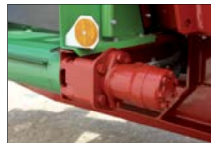
Hydromotoren – je nach Einsatzfall haben Sie die Auswahl aus unterschiedlich schnellen Motoren
