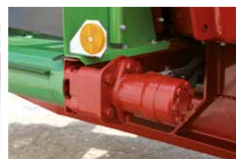
Hydromotoren – afhankelijk van de gebruikssituatie kunt u kiezen uit motoren met verschillende snelheid
