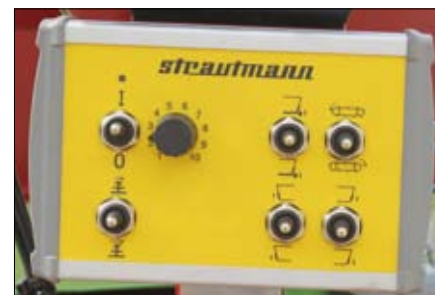
Bedieningsgedeelte met potentiometer
